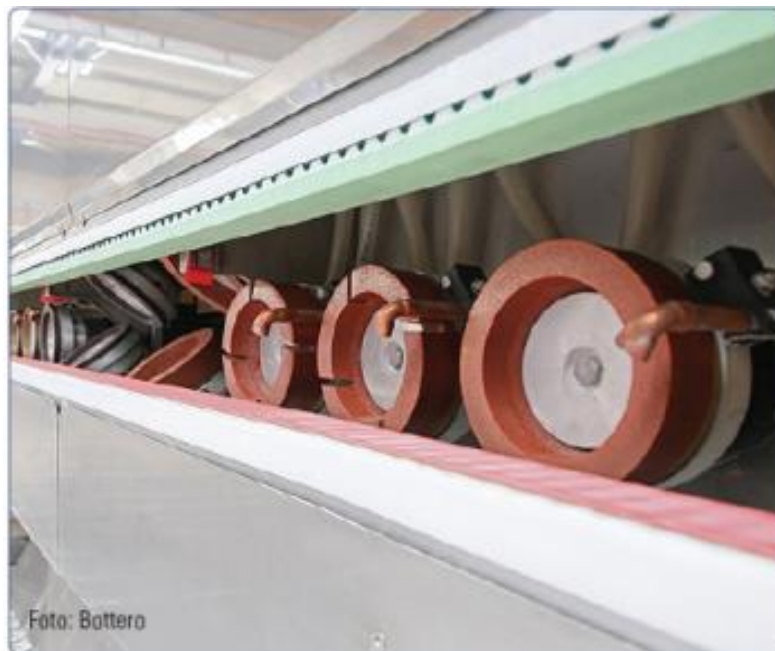
Der Antrieb der Schleifscheiben ist eine Aufgabe der Servoregler von KOLLMORGEN, die zweite besteht darin, die Scheiben exakt zu positionieren.
